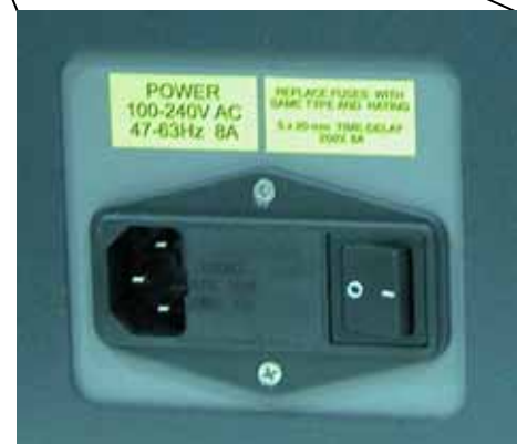
Mini 18 Power Receptacle
